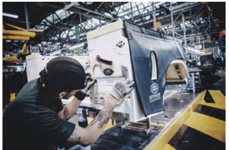
Der Modellname wird aufgebracht.
