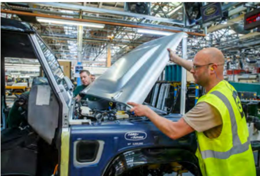
Die Motorhaube wird montiert.
